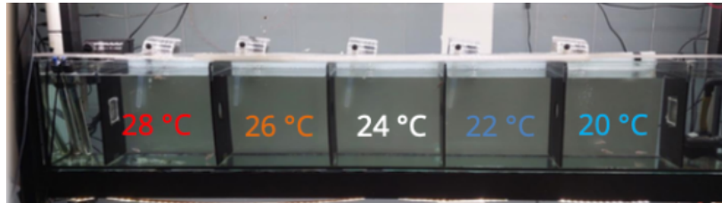
Figura 1. Tanque de gradiente térmico. El enfriador está situado a la derecha y el calentador a izquierda. Los compartimentos están conectados por un orificio de unos 5cms en mitad de los separadores.
